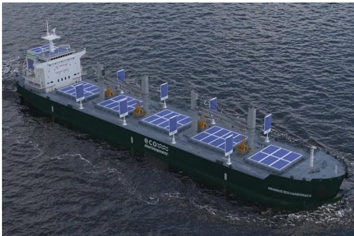
Şəkil 2. Gəmi üzərində günəş panellərinin tətbiqi
