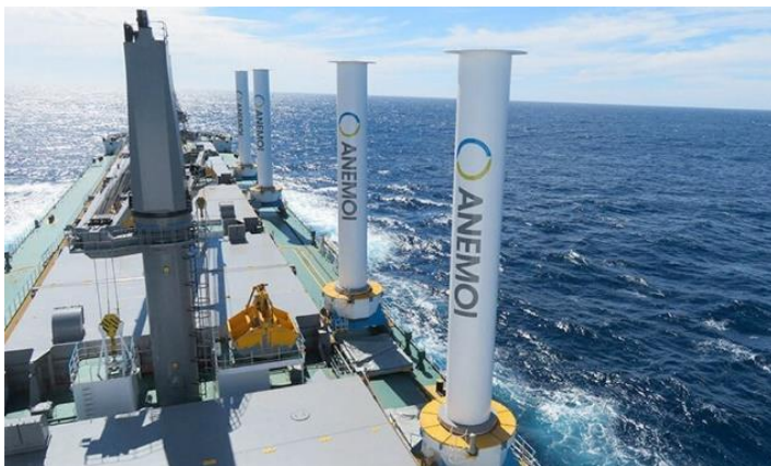
Şəkil 3. Gəmi üzərində flettner rotorlarının tətbiqi (külək enerjisi)
